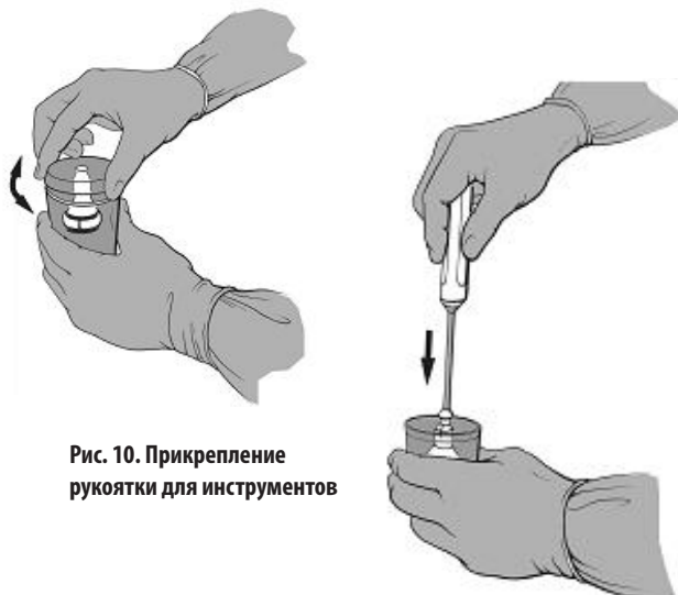
Рис. 9. Открывание наружного контейнера
