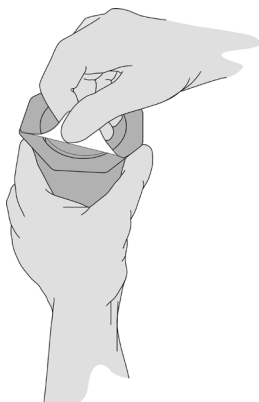
Figur 8a. Avdragbart yttre lock
