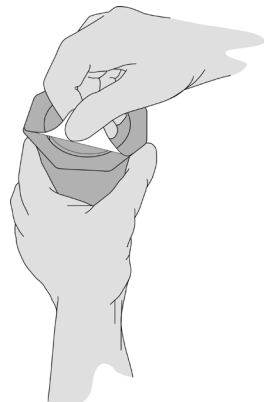
Şekil 8a. Sıyrır çıkar dış kapak
