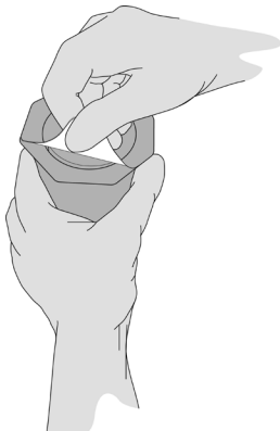
Abb. 8a. Abziehbarer Außendeckel
