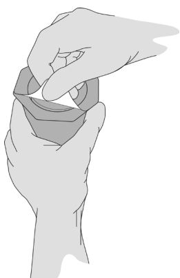
Figura 8a. Staccare il coperchio esterno
