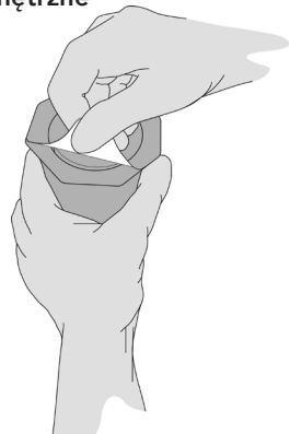
Rysunek 8a. Odrywanie wieczka zewnętrznego
