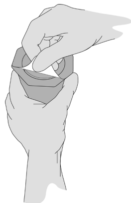
Figura 8a. Dezlipiți capacul extern
