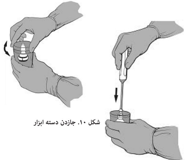
شکل ۹. بازکردن ظرف داخلی
