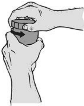
Joonis 7a. Keeratav väline kaas
