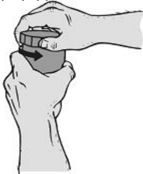
Εικόνα 7α: Εξωτερικό καπάκι αφαιρούμενο με περιστροφή
