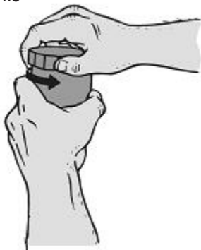
Figura 7a. Svitare e rimuovere il coperchio esterno
